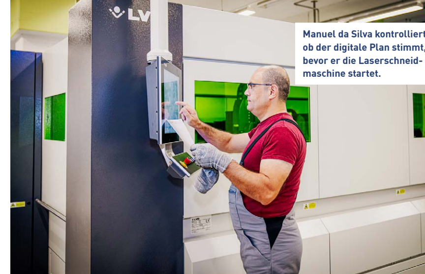
Anschliessend werden die Edelstahlplatten nach dem Plan vollautomatisiert zugeschnitten.
